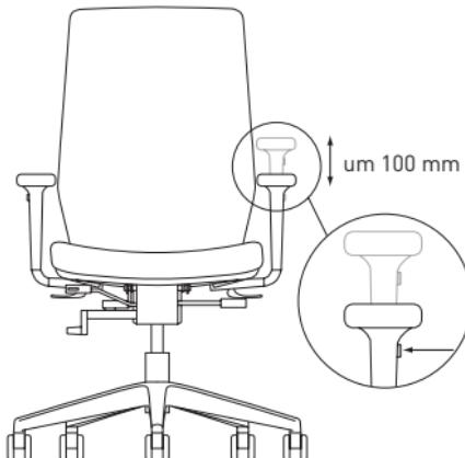
**Modellabhängig: l** depending on model: | selon le modèle : | afhankelijk van het model:
